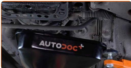
**13** Desenrosque el tapón de drenaje. Use un vaso de impacto del n.º 13. Utilice una llave de trinquete.
