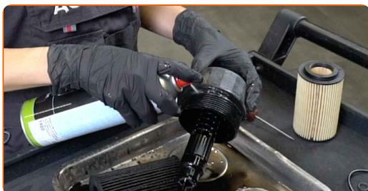
**18** Instale nuevas juntas tóricas y un nuevo filtro de aceite en los asientos de montaje de la tapa del filtro.
