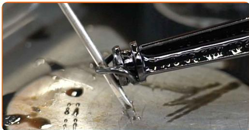
**16** Separe el filtro de aceite de la tapa del filtro. Utilice un destornillador plano.
