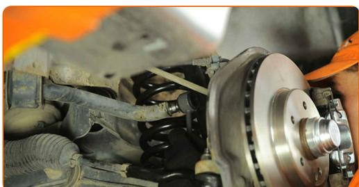
**12** Trate todas las juntas de la bieleta o enlace estabilizador. Use grasa de cobre.
