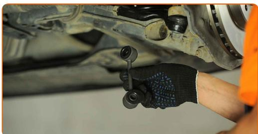
**11** Apriete la sujeción que conecta la barra estabilizadora con el brazo de control. Use una palanca. Utilice Torx T50. Utilice una llave dinamométrica. Apriételo a un par de 80 Nm.
