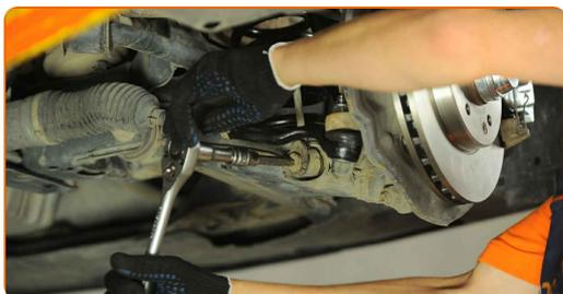
**8** Retire el enlace estabilizador de estabilidad transversal. Use una palanca.
