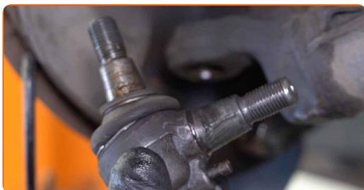
**12** Apoye la mangueta de dirección. Utilice un gato de transmisión hidráulica.
