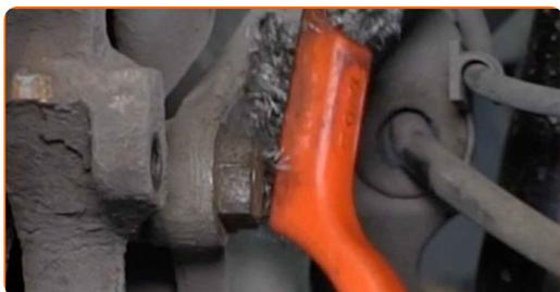
**16** Desenrosque las sujeciones del soporte de la pinza de freno. Use un vaso de impacto del n.º 18. Utilice una llave de trinquete.
