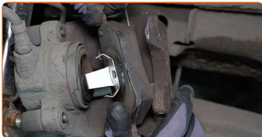
**15** Limpie las sujeciones del soporte de la pinza del freno. Use un cepillo de alambre. Use el aerosol WD-40.
