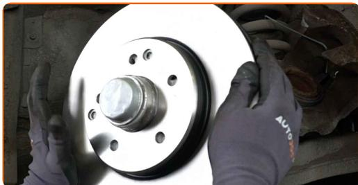
**26** Instale el perno de sujeción.
