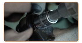
Desenrosque la sujeción superior del amortiguador.
