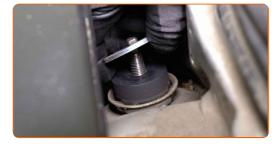
Retire los elementos del soporte superior del amortiguador.
