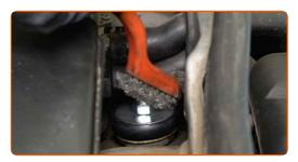
Afloje la sujecion superior del amortiguador. Utilice un vaso de impacto especial para extraer el amortiguador n° 16. Utilice un vaso para amortiguador DD6. Utilice una llave de trinquete.
