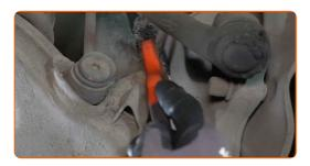
Apoye el brazo de control. Utilice un gato de transmisión hidráulica.
