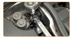
Instale la tapa del soporte del amortiguador.
