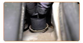
Atornille la sujeción superior del amortiguador.
