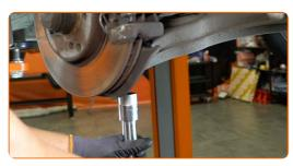
Desenrosque las sujeciones inferiores del amortiguador. Usa una llave mixta del n.º 17. Use un vaso de impacto del n.º 17. Utilice una llave de trinquete.
