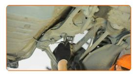
Apriete la sujeción que conecta el brazo de suspensión a la mangueta trasera. Usa una llave mixta del n.º 17. Utilice una llave dinamométrica. Apriételo a un par de 40 Nm.
