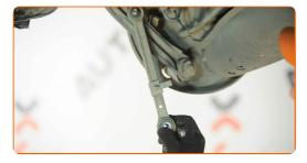
Limpie la sujeción del soporte del sensor ABS. Use un cepillo de alambre. Use el aerosol WD-40.
