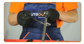
17 Instale la nueva palanca de suspensión.
