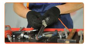
Apriete la fijación del soporte al brazo. Utilice Torx T20. Utilice una llave de trinquete.
