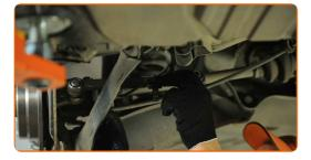
Instale la sujeción trasera del brazo de control.
