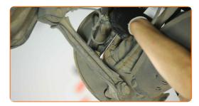
Conecte los cables del captador ABS.
