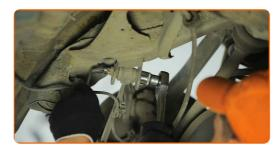
Retire la sujeción trasera del brazo de control. Utilice un martillo.
