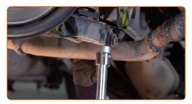
Instale el perno de sujeción. Use una palanca.
