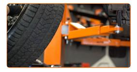
Desenrosque las sujeciones de la cubierta del brazo de control. Use un vaso de impacto del n.º 10. Utilice una llave de trinquete.
