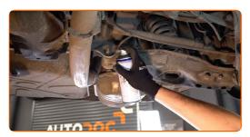
Afloje la sujeción que conecta el brazo de control al subchasis trasero. Usa una llave mixta del n.º 19. Use un vaso de impacto del n.º 19. Utilice una llave giramachos.
