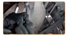
Retire la cubierta del brazo de control.
