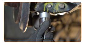
Apriete la sujeción que conecta el brazo de control con el subchasis trasero. Usa una llave mixta del n.º 19. Use un vaso de impacto del n.º 19. Utilice una llave dinamométrica. Apriételo a un par de 90 Nm.
