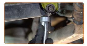
Instale el compresor de resorte helicoidal en el resorte helicoidal.
