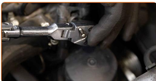
**17** Destornille la tapa del cuerpo del filtro junto con el elemento filtrante antiguo. Utilice el vaso 76/15F. Utilice una llave de trinquete.
