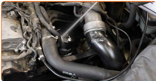
**16** Desenrosque las sujeciones de la manguera de vacío y la manguera de la dirección asistida hidráulica. Use un vaso de impacto del n.º E12. Utilice una llave de trinquete.
