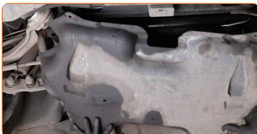
**11** Coloque un contenedor para el aceite de desecho con al menos 7 l de capacidad debajo del orificio de drenaje.
