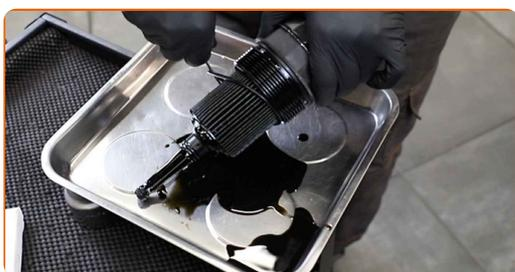
**21** Separe el filtro de aceite de la tapa del filtro. Utilice un destornillador plano.
