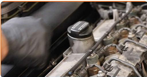
**42** Pongan en marcha el motor por unos minutos. Después de que se apague la luz de advertencia de presión del aceite, detenga el motor.
