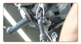
Atornille la fijación del brazo con el muñón. Usa una llave mixta del n.º 18. Utilice una llave dinamométrica. Apriételo a un par de 50 Nm.+90°
