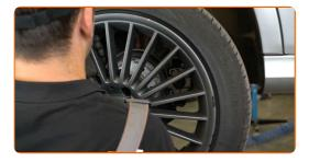
Desenrosque las sujeciones de la cubierta protectora de plástico de la carrocería. Use un vaso de impacto del n.º 10. Utilice una llave de trinquete.
