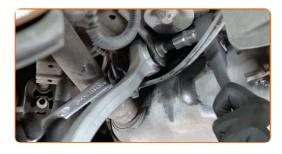
18 Instale el perno de sujeción.
