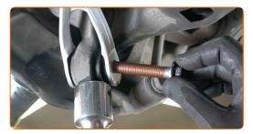
Atornille las sujeciones que conectan el brazo de control a la mangueta trasera. Usa una llave mixta del n.º 18. Use un vaso de impacto del n.º 18. Utilice las puntas XZN #12. Utilice una llave de trinquete.
