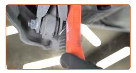
Desatornille la sujeción que conecta el brazo de control a la mangueta trasera. Usa una llave mixta del n.º 18. Use un vaso de impacto del n.º 18. Utilice las puntas XZN #12. Utilice una llave de trinquete.
