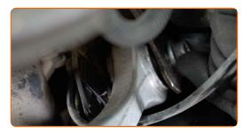
Atornille la sujeción que conecta el brazo de control al subchasis. Usa una llave mixta del n.º 18. Use un vaso de impacto del n.º 18. Utilice las puntas XZN #12. Utilice una llave de trinquete.
