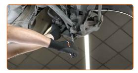
Destornille la fijación de la palanca del bastidor auxiliar. Usa una llave mixta del n.º 18. Use un vaso de impacto del n.º 18. Utilice las puntas XZN #12. Utilice una llave de trinquete.
