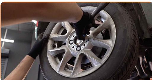
**21** Baje el automóvil y, manteniendo el orden cruzado, apriete los pernos de fijación de las ruedas. Utilice una llave dinamométrica. Apriételo a un par de 98 Nm.
