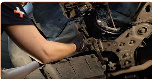
**19** Instale y apriete las sujeciones de la cubierta del paso de rueda. Use un vaso de impacto del n.º 10. Utilice una llave de trinquete. Utilice un destornillador Phillips.
