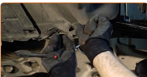
**20** Limpie el asiento de montaje de la llanta de la rueda. Use un cepillo de alambre. Trate la superficie de contacto. Use grasa de cobre.
