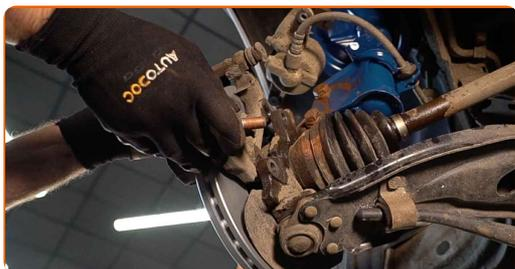
**19** Apriete la fijación de la pinza del cáliper de freno. Use un vaso de impacto del n.º 19. Utilice una llave dinamométrica. Apriételo a un par de 57 Nm.
