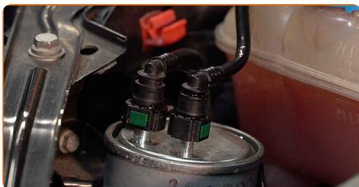
**4** Apriete los clips y separe las líneas de suministro de combustible de la carcasa del filtro de aceite. Utilice alicates para conectores de tubos de combustible.
