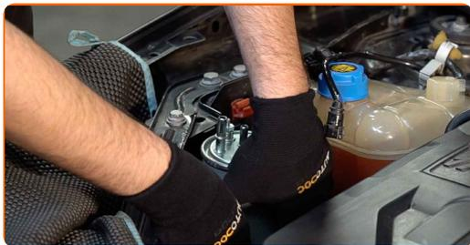
**10** Apriete la fijación del filtro de combustible. Use un vaso de impacto del n.º 10. Utilice una llave de trinquete.
