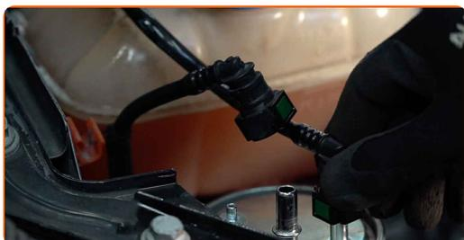
**12** Conecte el kit para purgado al tornillo de purga del filtro de combustible.
