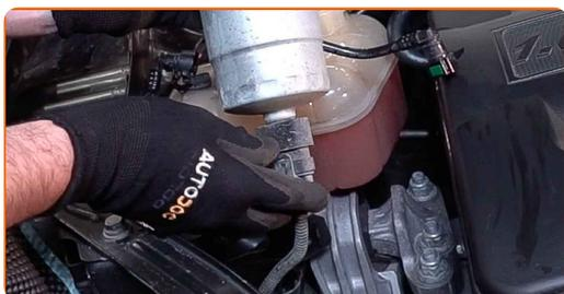
**8** Conecte el conector del sensor de presión de combustible.
