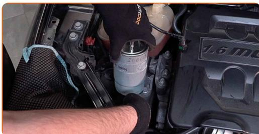
**7** Desconecte el conector del sensor de presión de combustible.
