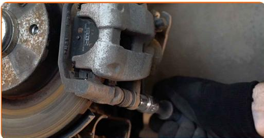
**8** Retire el soporte de freno. Use una palanca.
