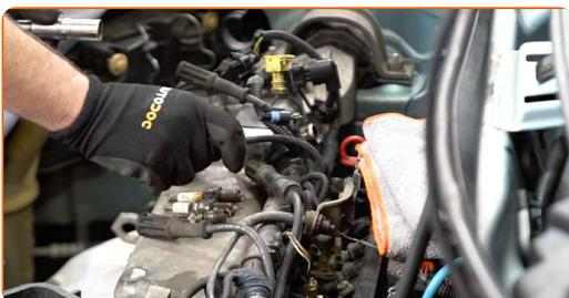
**13** Aplique una capa fina de un lubricante antigripado especial de alta temperatura a las roscas de las nuevas bujías.
