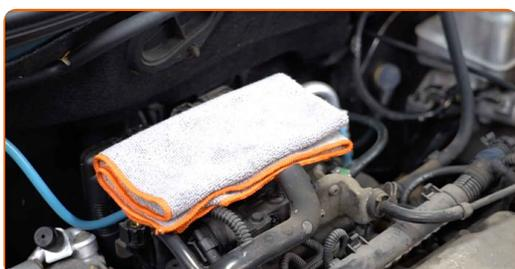
**7** Separe el manguito de ventilación del cárter de la cubierta del motor en la izquierda. Use una palanca.
