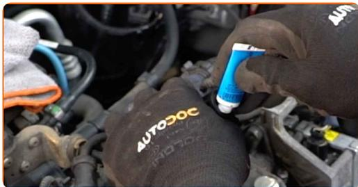
**17** Instale los conectores del cable de bujía en los pozos de la bujía. Asegúrese de que escucha un sonido clic indicando que está bloqueado en su lugar.
