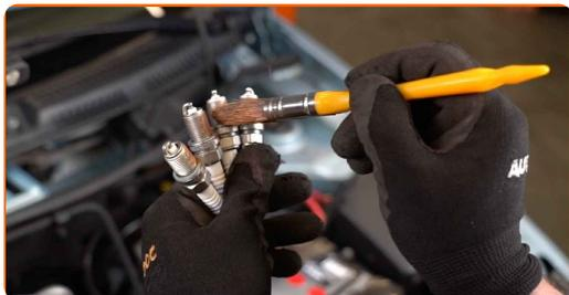
**14** Instale las nuevas bujías en sus asientos de montaje. Use el vaso de bujía # 16.
