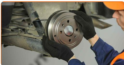
**19** Apriete las sujeciones del tambor del freno. Use un vaso de impacto del n.º 12. Utilice una llave dinamométrica. Apriételo a un par de 15 Nm.
