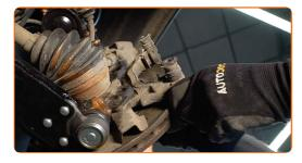
Limpie las sujeciones del disco de freno. Use un cepillo de alambre. Use el aerosol WD-40.
