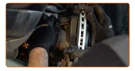
Apriete la fijación de la pinza del cáliper de freno. Use un vaso de impacto del n.º 19. Utilice una llave dinamométrica. Apriételo a un par de 110 Nm.
