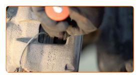
Limpie las sujeciones de la pinza del freno. Use un cepillo de alambre. Use el aerosol WD-40.
