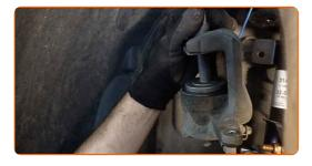
Establezcan el soporte de freno y lo fijen. Use un vaso de impacto del n.º 13. Utilice una llave dinamométrica. Apriételo a un par de 30 Nm.
