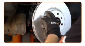
Apriete la fijación del disco de freno. Use un vaso de impacto del n.º 12. Utilice una llave dinamométrica. Apriételo a un par de 10 Nm.
