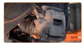
Destornille la fijación del cáliper de freno. Use un vaso de impacto del n.º 13. Utilice una llave de trinquete.
