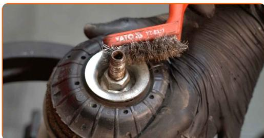
**27** Destornille la tuerca de la varilla de la pata amortiguadora. Use Vaso HEX No. H6. Use un vaso de impacto del n.º 18. Utilice una llave de trinquete.
