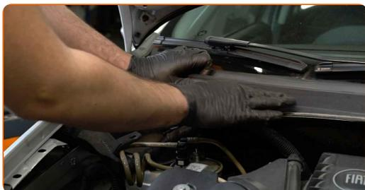
**63** Apriete las sujeciones de la rejilla del limpiaparabrisas. Utilice un destornillador Phillips.
