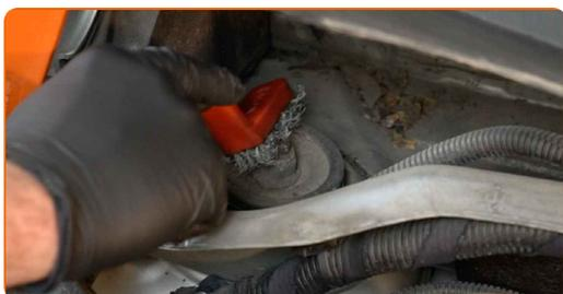
**8** Afloje la sujeción superior del soporte del amortiguador. Use una llave mixta del n.º 18. Use Vaso HEX No. H6. Utilice una llave de trinquete.
