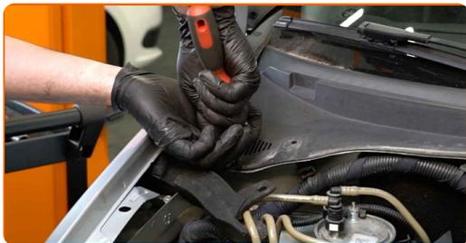
**64** Instale las sujeciones de la rejilla de plástico del capó del limpiaparabrisas.
