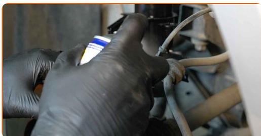
**45** Fije la pata amortiguadora en el muñón de dirección.
