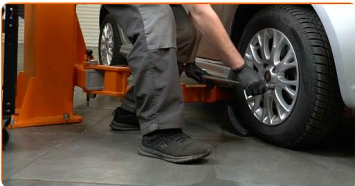
**11** Levante la parte delantera del automóvil y fije la posición sobre los pedestales.
