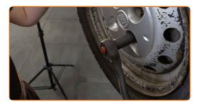
Baje el automóvil y, manteniendo el orden cruzado, apriete los pernos de fijación de las ruedas. Utilice una llave dinamométrica. Apriételo a un par de 98 Nm.
