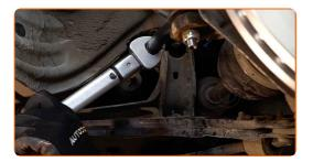
Apriete la tuerca de fijación que conecta el extremo de la barra de acoplamiento a la mangueta de dirección. Use un vaso de impacto del n.º 17. Utilice una llave dinamométrica. Apriételo a un par de 49 Nm.
