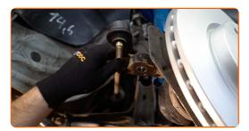
Atornille la contratuerca del extremo de la barra de acoplamiento de dirección. Usa una llave mixta del n.º 22.
