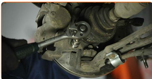
**40** Conecte la fijación del latiguillo de freno a la pata amortiguadora.
