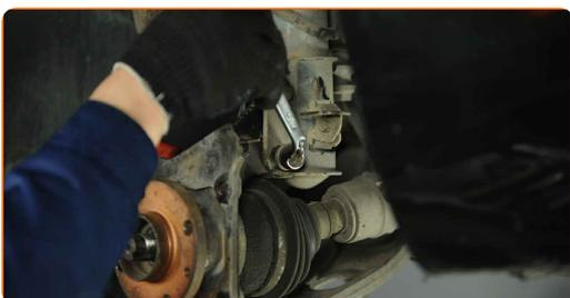
**34** Instale el captador ABS en el muñón de dirección y fíjelo. Use un vaso de impacto del n.º 10.
