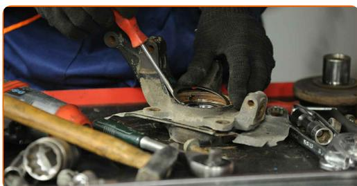
**29** Presione el cubo de la rueda en el cargador interior del cojinete.
