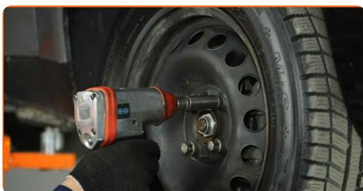
**45** Baje el automóvil y, manteniendo el orden cruzado, apriete los pernos de fijación de las ruedas. Utilice una llave dinamométrica. Apriételo a un par de 98 Nm.
