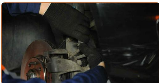
**33** Conecte la fijación del cable del sensor ABS a la pata amortiguadora.
