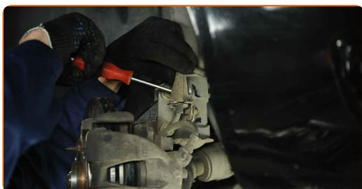
**8.1** Destornille la fijación inferior de la pata amortiguadora.
