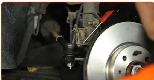
**7** Desconecte la fijación de la manguera de freno de la conexión con la pata amortiguadora. Utilice un destornillador plano.
