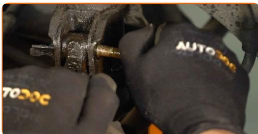
**10** Desconecte el muñón de dirección de la pata amortiguadora. Utilice un destornillador plano.
