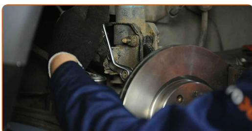
**32** En la pata fije el latiguillo del sistema de freno.
