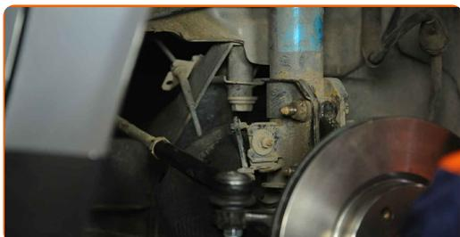
**34** Trate las sujeciones del amortiguador. Use grasa de cobre.
