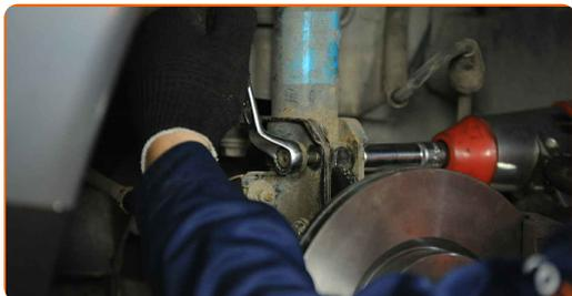
**31.2** Use un vaso de impacto del n.º 15. Usa una llave mixta del n.º 17. Utilice una llave dinamométrica. Apriételo a un par de 75 Nm.
