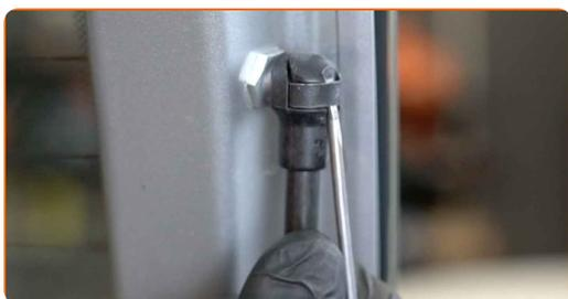
**4** Libere el anillo de seguridad que conecta el amortiguador de gas a la carrocería del automóvil. Utilice un destornillador plano.
