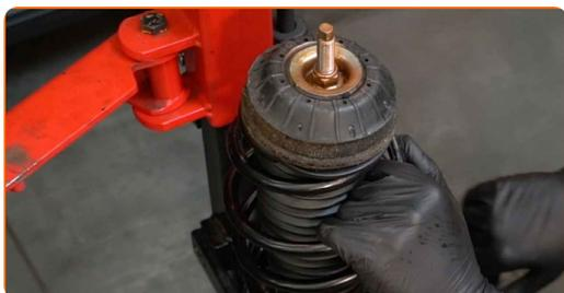
**42** Instale la pata amortiguadora en el arco de la rueda.
