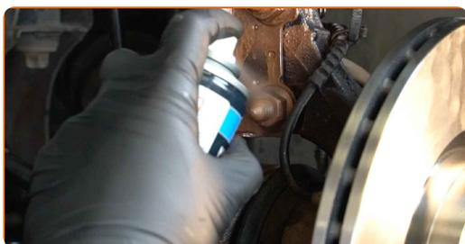
**54** Trate la superficie donde el disco del freno entra en contacto con la llanta de la rueda. Use grasa de cobre.
