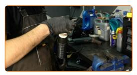
Apriete la tuerca de la varilla del amortiguador. Utilice un vaso para amortiguador DD№6. Use un vaso de impacto del n.º 16. Utilice una llave dinamométrica. Apriételo a un par de 35 Nm.
