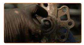
Destornille la fijación de la varilla del amortiguador. Utilice un vaso para amortiguador DDNº6. Use un vaso de impacto del n.º 16. Utilice una llave de trinquete.
