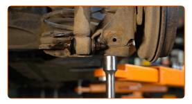
Destornille la fijación inferior del amortizador. Use un vaso de impacto del n.º E18. Utilice una llave de trinquete.
