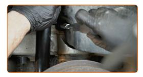
Apriete la fijación inferior del amortiguador. Use un vaso de impacto del n.º E18. Utilice una llave dinamométrica. Apriételo a un par de 120 Nm.
