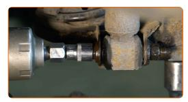
Destornille la fijación superior del amortiguador. Use un vaso de impacto del n.º E16. Utilice una llave de trinquete.
