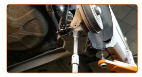
Apriete la fijación superior del amortiguador. Use un vaso de impacto del n.º E16. Utilice una llave dinamométrica. Apriételo a un par de 72 Nm.
