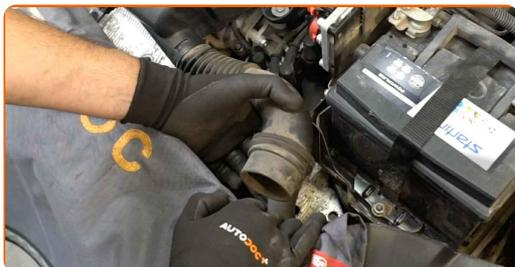
**4** Afloje los tornillos de sujeción de la cubierta del filtro de aire. Use un vaso de impacto del n.º 10. Utilice una llave de trinquete.
