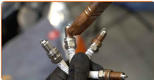
**13** Instale las nuevas bujías en sus asientos de montaje. Use el vaso de bujía # 16.
