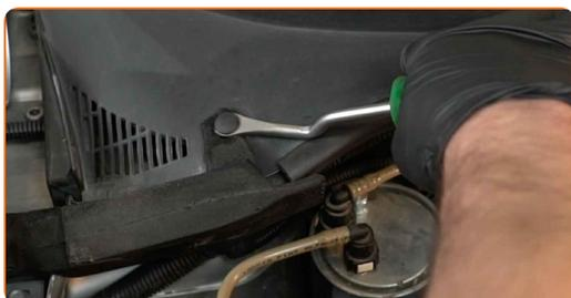
**4** Desenrosque las sujeciones de la rejilla del limpiaparabrisas. Utilice un destornillador Phillips.
