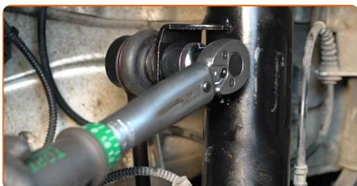
**51** Trate las sujeciones del amortiguador. Use grasa de cobre.
