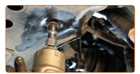
Apriete la sujeción delantera que conecta el brazo de control al subchasis. Use un vaso de impacto del n.º E18. Utilice una llave dinamométrica. Apriételo a un par de 60 Nm.+90°
