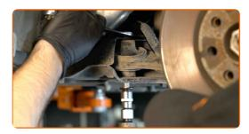
Retire los pernos de sujeción. Use un vaso de impacto del n.º E18. Utilice una llave de trinquete.
