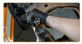
Retire el perno de sujeción.
