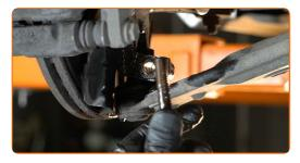
Destornille la fijación delantera de la palanca. Use un vaso de impacto del n.º E18. Utilice una llave giramachos.
