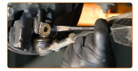
Desconecte el soporte esférico del muñón de dirección.
