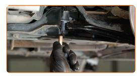
Atornille la sujeción trasera que conecta el brazo de control al subchasis. Usa una llave mixta del n.º 18. Use un vaso de impacto del n.º E18. Utilice una llave de trinquete.
