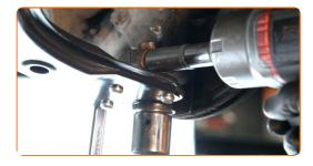
Atornille la sujeción trasera que conecta el brazo de control al subchasis. Usa una llave mixta del n.º 18. Use un vaso de impacto del n.º E18. Utilice una llave de trinquete.
