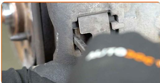
9 Retire el clip de retención del pasador de bloqueo. Use alicates de punta redondeada.
