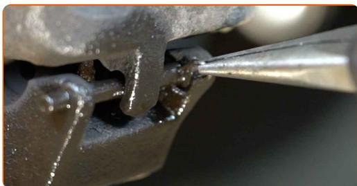
10 Retire el tornillo clavija de la pinza de freno. Use un punzón. Utilice un martillo.
