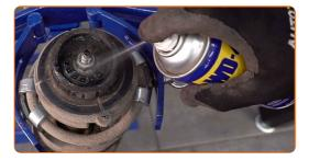
Destornille la tuerca de la varilla de la pata amortiguadora. Usa una llave mixta del n.º 19. Use Vaso HEX No. H6. Utilice una llave de trinquete.
