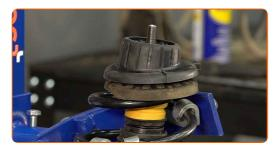
Apriete la tuerca de la varilla de la pata amortiguadora. Usa una llave mixta del n.º 19. Use Vaso HEX No. H6. Utilice una llave dinamométrica. Apriételo a un par de 60 Nm.
