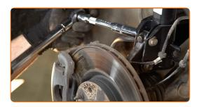
Trate todas las juntas de la bieleta o enlace estabilizador. Use el aerosol WD-40.
