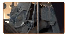
Limpie las fijaciones que conectan la bieleta de la barra estabilizadora al puntal amortiguador, y aquellos que conectan el puntal del amortiguador a la mangueta de rueda.
