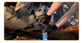
Desatornille la sujeción inferior que conecta el puntal amortiguador a la mangueta de dirección. Usa una llave mixta del n.º 15. Use un vaso de impacto del n.º 17. Utilice una llave giramachos.
