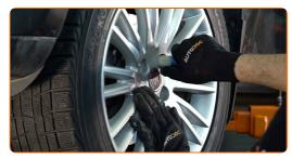
Baje el automóvil y, manteniendo el orden cruzado, apriete los pernos de fijación de las ruedas. Utilice una llave dinamométrica. Apriételo a un par de 120 Nm.
