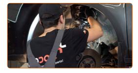
Atornillen la fijación superior de la cazoleta de la pata amortiguadora. No lo apriete.
