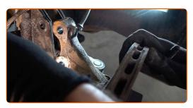
Destornille la fijación superior de la cazoleta de la pata amortiguadora. Use un vaso de impacto del n.º 19. Utilice una llave de trinquete.
