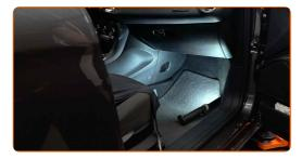
Levante, suelte cuidadosamente de las sujeciones y retire el panel de guarnecido lateral en el lado del pasajero.
