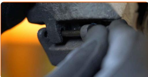
**30** Instale el clip de retención del pasador de bloqueo. Use alicates de punta redondeada.
