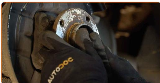
**19** Limpie el asiento de montaje del cojinete del cubo (buje). Utilice un spray de limpieza multiuso.
