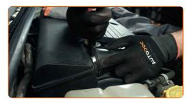
Conecte el tubo de entrada de aire a la carcasa del filtro de aire.
