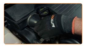
Fije la abrazadera en el manguito de admisión de aire. Utilice alicates para abrazaderas clic-R.
