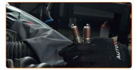
15 Instale las nuevas bujías en sus asientos de montaje.
