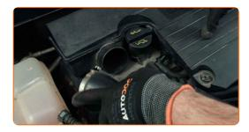
Destornille los bulones de fijación del cuerpo del filtro. Use un vaso de impacto del n.º 10. Utilice una llave de trinquete.
