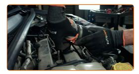
Retire los conectores del cable de bujías de los pozos de la bujía. Use alicates de punta redondeada.
