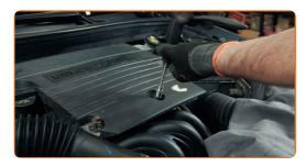
Fije el manguito de ventilación del cárter a la cubierta del motor a la izquierda.
