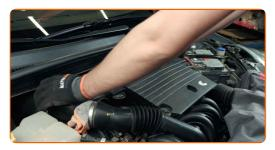
Introduzca los pernos de fijación del cuerpo del filtro. Use un vaso de impacto del n.º 10. Utilice una llave de trinquete.
