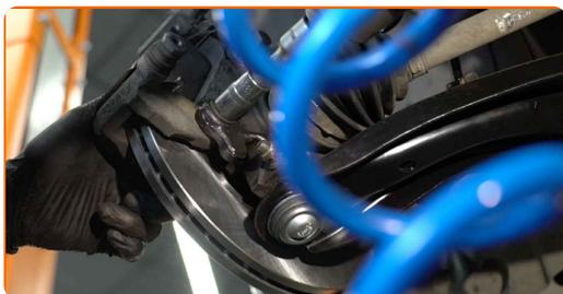
**20** Trate el pistón de la pinza de freno. Utilice un cepillo de limpieza de nylon. Use un limpiador de frenos.
