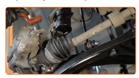
Destornille la fijación del cáliper de freno. Usa una llave mixta del n.º 12.
