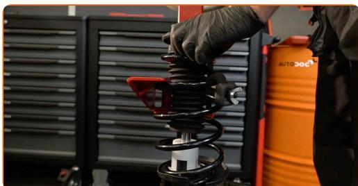
**37** Instale el soporte de montaje superior del puntal y el cojinete del soporte de montaje del puntal.
