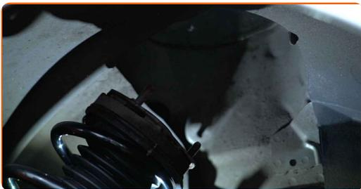
**44** Atornillen la fijación superior de la cazoleta de la pata amortiguadora. No lo apriete.
