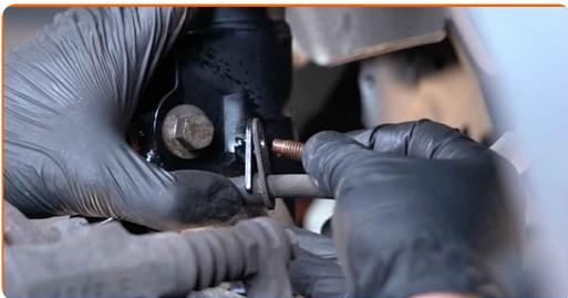
**51** Conecte la fijación del latiguillo de freno a la pata amortiguadora. Use un vaso de impacto del n.º 10. Utilice una llave dinamométrica. Apriételo a un par de 7 Nm.
