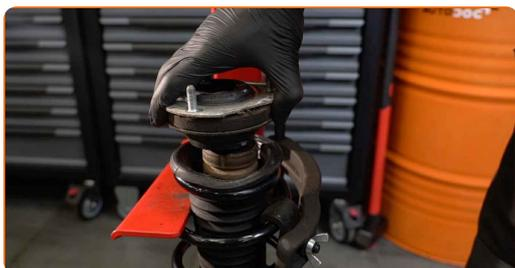
**38** Apriete la tuerca de la varilla de la pata amortiguadora. Use Vaso HEX No. H6. Use un vaso de impacto del n.º 18. Utilice una llave dinamométrica. Apriételo a un par de 48 Nm.
