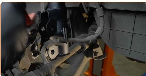
**46** Fije la pata amortiguadora en el muñón de dirección.
