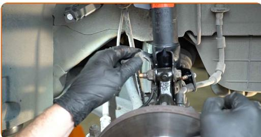
**53** Instale la barra del estabilizador de estabilidad transversal.
