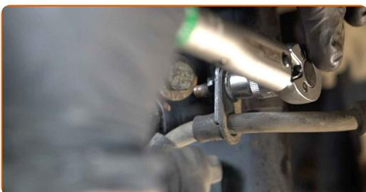
**52** Conecte los cables del captador ABS.
