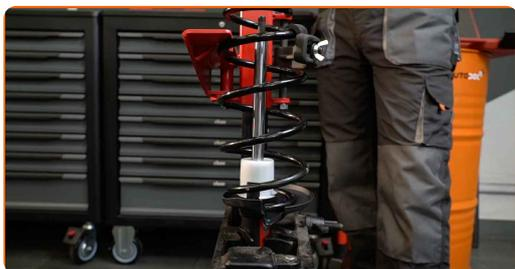
**36** Instale el guardapolvo y el tope en el amortiguador nuevo.
