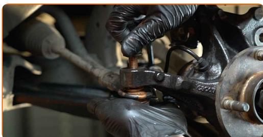
**56** Atornille la tuerca de sujeción que conecta el extremo de la barra de acoplamiento a la mangueta de dirección. Use un vaso de impacto del n.º 18. Utilice una llave de trinquete.
