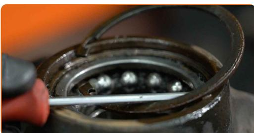
**39** Limpie el asiento de montaje del cojinete del cubo (bujes). Use un cepillo de alambre. Use el aerosol WD-40.
