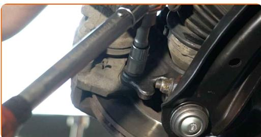
**69** En la pata fije el latiguillo del sistema de freno.
