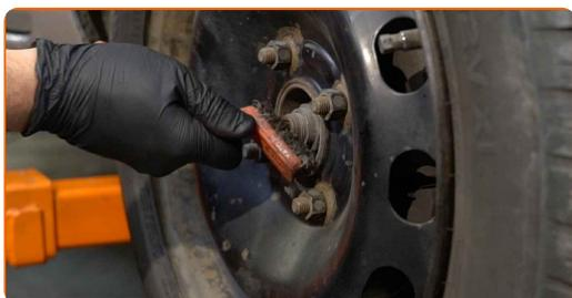
**2** Afloje la sujeción del eje de transmisión. Use un vaso de impacto del n.º 32. Utilice una llave giramachos.
