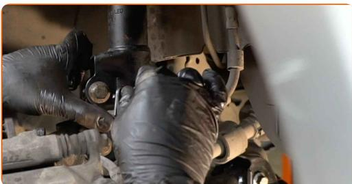
**70** Conecte la fijación del latiguillo de freno a la pata amortiguadora. Use un vaso de impacto del n.º 10. Utilice una llave dinamo-métrica. Apriételo a un par de 7 Nm.
