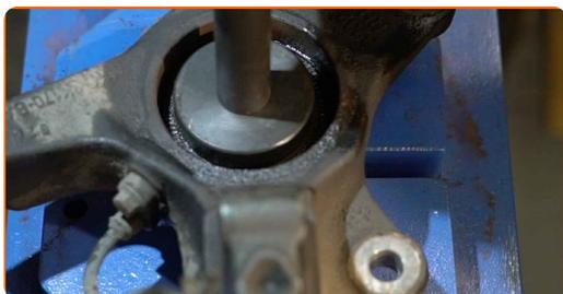
**41** Limpie el asiento de montaje del cojinete del cubo (bujes). Use un cepillo de alambre. Use el aerosol WD-40.
