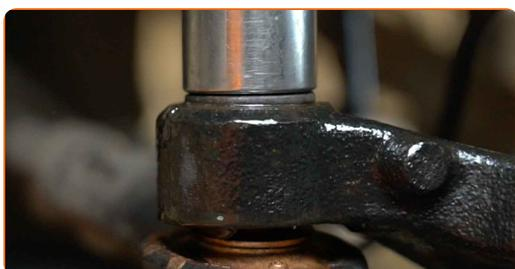
**57** Instale el perno de sujeción.
