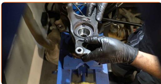
**46** Instale el muñón de dirección una vez ensamblado con el cubo.
