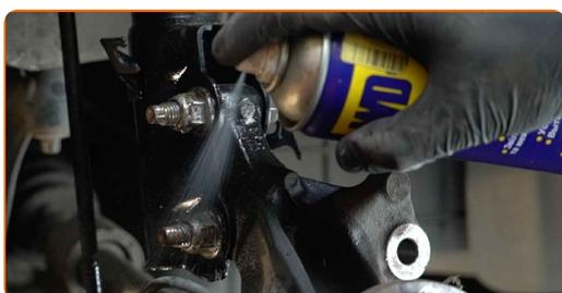
**20** Desatornille la sujeción inferior que conecta el puntal amortiguador a la mangueta de dirección. Usa una llave mixta del n.º 15. Use un vaso de impacto del n.º 18. Utilice una llave de trinquete.
