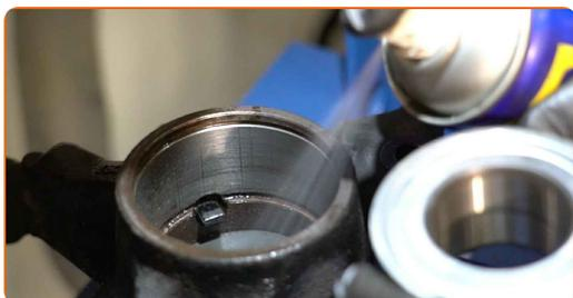
**42** Inserte presionando el rodamiento nuevo en el muñón de dirección.
