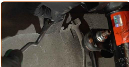
**18** Suelte el conector del sensor ABS.
