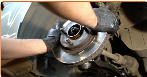
**67** Instale la pinza del freno junto con su soporte.
