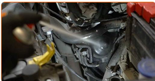
**17** Destornille la tapa del cuerpo del filtro junto con el elemento filtrante antiguo. Use un vaso de impacto del n.º 27. Utilice una llave de trinquete.
