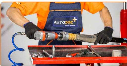
18 Trate los asientos de montaje del amortiguador. Use un cepillo de alambre. Use el aerosol WD-40.
