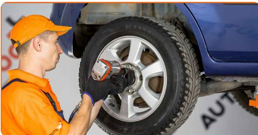
30 Baje el automóvil y, manteniendo el orden cruzado, apriete los pernos de fijación de las ruedas. Utilice una llave de impacto para llanta # 19. Utilice una llave dinamométrica. Apriételo a un par de 95 Nm.
