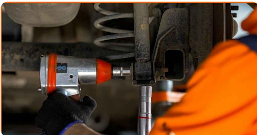
9 Retire el perno de sujeción.
