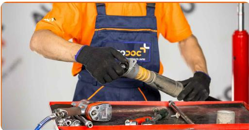
17 Atornille la fijación de la cazoleta del amortiguador. Use un vaso de impacto del n.º 13. Utilice una llave dinamométrica. Apriételo a un par de 25 Nm.
