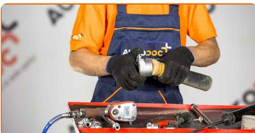
16 Instale el soporte, el fuelle y el tope en el amortiguador.
