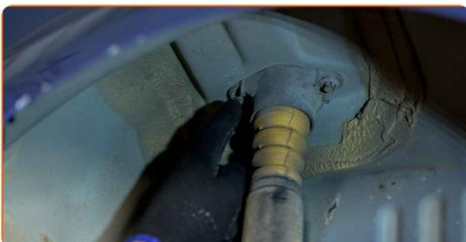
8 Destornille la fijación inferior del amortiguador. Use un vaso de impacto del n.º 15. Utilice una llave de trinquete.
