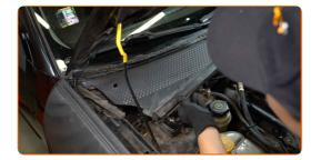
Atornille las sujeciones de la rejilla de la capucha del limpiaparabrisas situada en el lado derecho. Utilice un destornillador Phillips.
