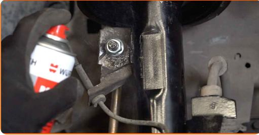
9 Desatornille la sujeción que conecta la bieleta de barra estabilizadora al amortiguador. Use un vaso de impacto del n.º 15. Utilice una llave de trinquete.
