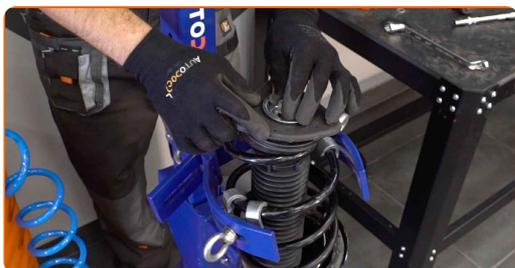
**39** Apriete la tuerca de la varilla de la pata amortiguadora. Use Vaso HEX No. H6. Usa una llave mixta del n.º 19. Utilice una llave dinamométrica. Apriételo a un par de 50 Nm.
