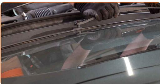
**59** Apriete las fijaciones de los brazos del limpiaparabrisas. Use un vaso de impacto del n.º 15. Utilice una llave dinamométrica. Apriételo a un par de 10 Nm.
