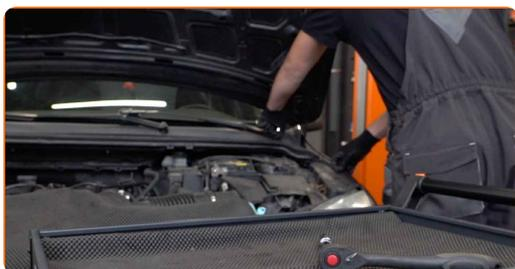
**4** Desenrosque las fijaciones de los brazos del limpiaparabrisas. Use un vaso de impacto del n.º 15. Utilice una llave de trinquete.
