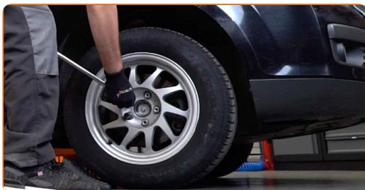
**14** Levante la parte delantera del automóvil y fije la posición sobre los pedestales.
