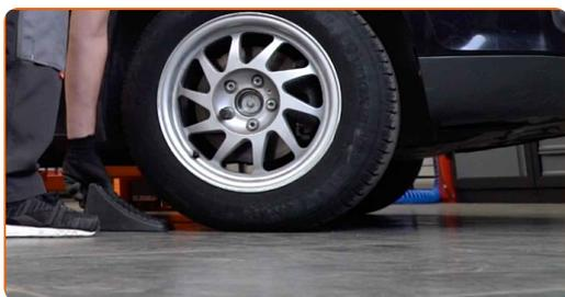
**13** Afloje los pernos de fijación de la rueda. Utilice una llave de impacto para llanta # 19.
