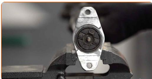
**17** Fije la cazoleta del amortiguador. Use una llave mixta del n.º 13. Use un vaso de impacto del n.º 13. Utilice una llave dinamométrica. Use una llave ajustable. Apriételo a un par de 25 Nm.
