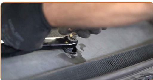
Sustitución: copelas del amortiguador - FORD C-MAX (DM2). Consejo:
