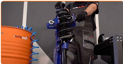
**37** Retire el puntal amortiguador que está montado.
