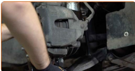
**24** Destornille la fijación superior de la pata amortiguadora.
