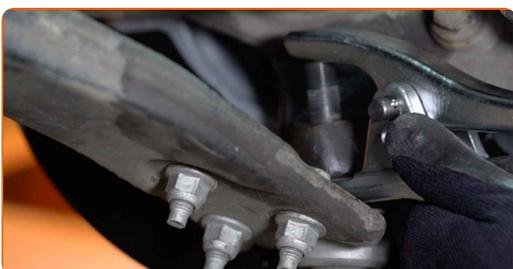
**10** Destornille la fijación delantera de la palanca. Use un vaso de impacto del n.º 18. Utilice una llave de trinquete.
