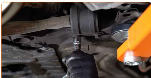
**13** Retire la sujeción trasera del brazo de control.
