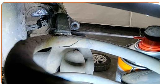
**17** Suelte el conector del sensor ABS. Utilice un destornillador plano.
