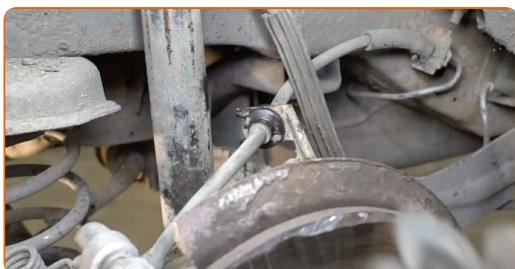
**32** Instale el cable del freno de estacionamiento en el soporte de la pinza del freno. Use alicates de bomba de agua.
