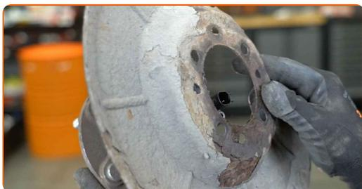
**21** Limpie el asiento de montaje del cojinete del cubo (buje). Use un cepillo de alambre. Use el aerosol WD-40.
