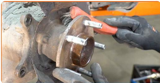
**16** Limpie el asiento de montaje del sensor ABS. Utilice un spray de limpieza multiuso.
