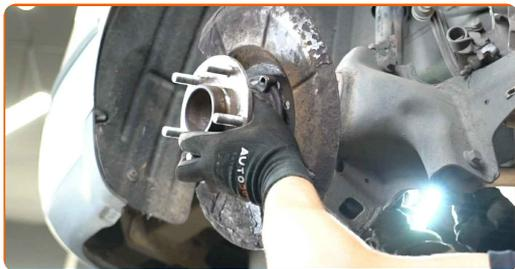
**20** Retire la placa deflectora del disco de freno.
