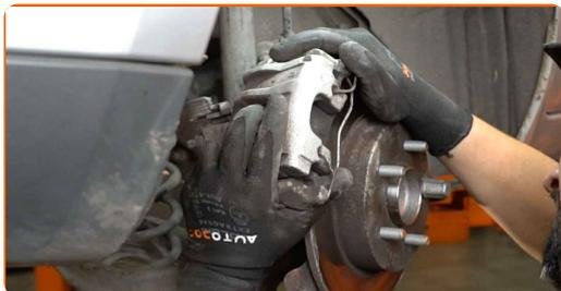
**30** Apriete la fijación de la pinza del cáliper de freno. Use un vaso de impacto del n.º 13. Utilice una llave dinamométrica. Apriételo a un par de 55 Nm.
