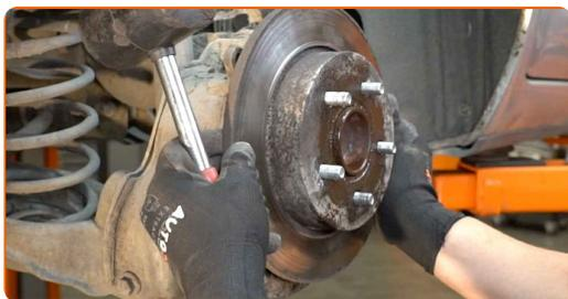
**15** Limpie las sujeciones del rodamiento del cubo de rueda. Use un cepillo de alambre. Use el aerosol WD-40.
