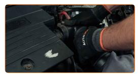
Suelte la abrazadera del manguito de admisión de aire. Utilice alicates para abrazaderas clic-R.
