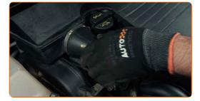
Fije la abrazadera en el manguito de admisión de aire. Utilice alicates para abrazaderas clic-R.
