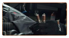
15 Instale las nuevas bujías en sus asientos de montaje.
