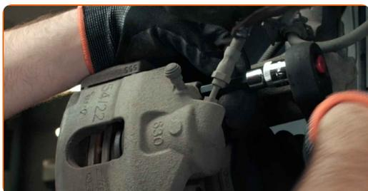
10 Separe el muelle de retención de la pinza de freno. Use una palanca.
