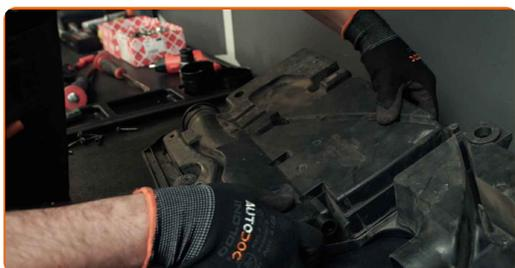
**16** Atornille los tornillos de sujeción de la cubierta del filtro de aire. Utilice Torx T27. Utilice una llave de trinquete.
