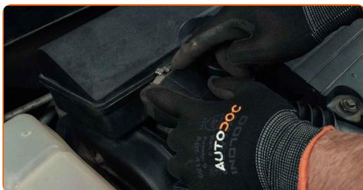
**22** Fije la abrazadera en el manguito de admisión de aire. Utilice alicates para abrazaderas clic-R.
