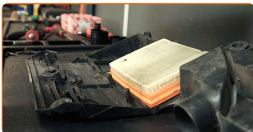
**12** Saque de la carcasa del filtro el elemento filtrante de recambio.
