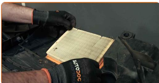
**13** Limpie la cubierta y la carcasa del filtro de aire.
