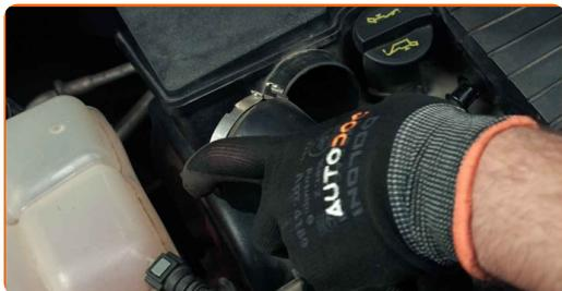
**6** Destornille los bulones de fijación del cuerpo del filtro. Use un vaso de impacto del n.º 10. Utilice una llave de trinquete.
