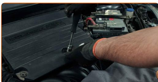
**7** Separe el manguito de ventilación del cárter de la cubierta del motor en la izquierda.
