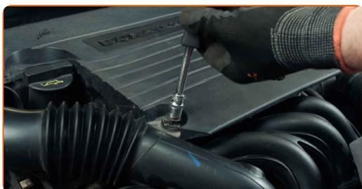
**19** Fije el manguito de ventilación del cárter a la cubierta del motor a la izquierda.
