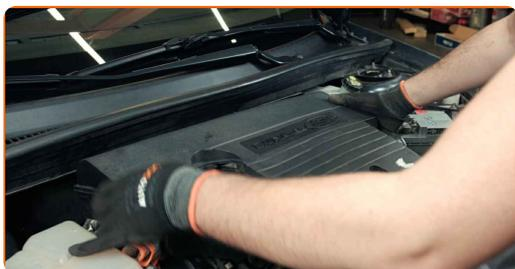
**18** Introduzca los pernos de fijación del cuerpo del filtro. Use un vaso de impacto del n.º 10. Utilice una llave de trinquete.
