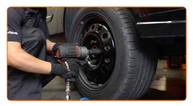
Baje el automóvil y, manteniendo el orden cruzado, apriete los pernos de fijación de las ruedas. Utilice una llave de impacto para llanta # 19. Utilice una llave dinamométrica. Apriételo a un par de 110 Nm.
