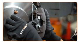
Apriete las sujeciones de la pinza del freno. Use Vaso HEX No. H7. Utilice una llave dinamométrica. Apriételo a un par de 28 Nm.
